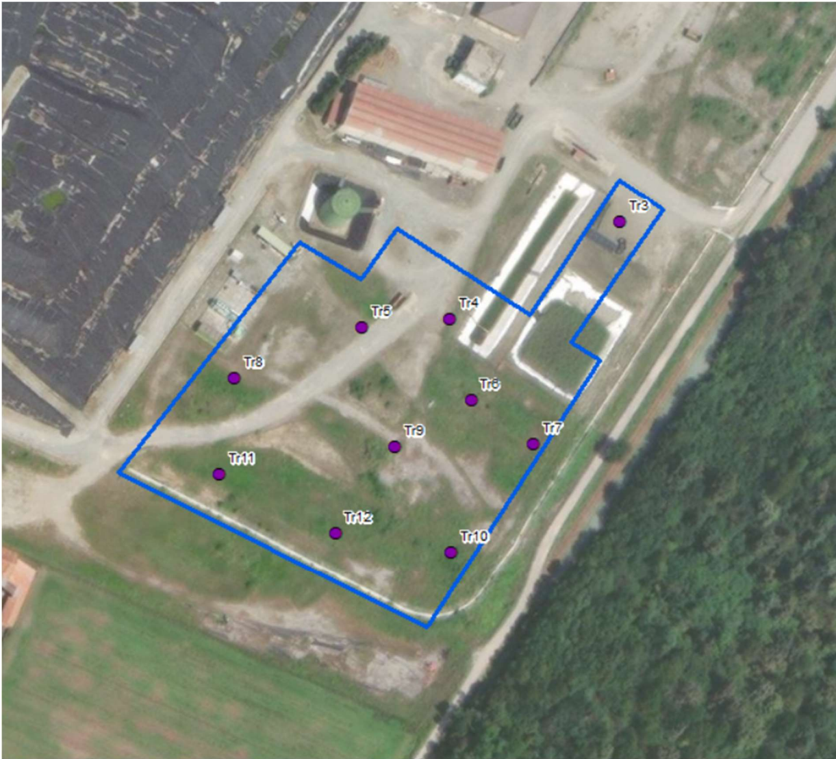
Figura 20 – Ubicazione n. 10 scavi geognostici
