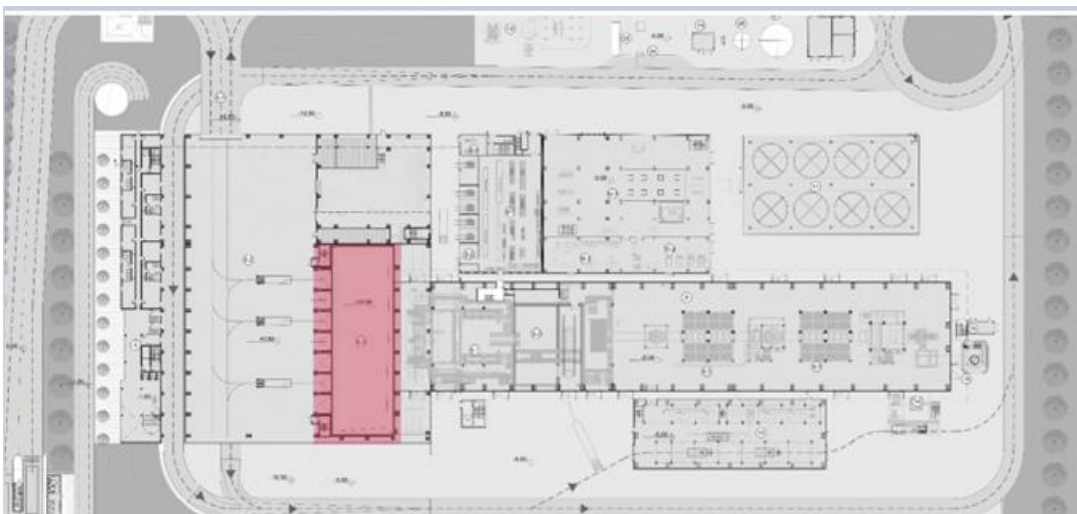
Fig. 13: Vasca principale di stoccaggio rifiuti
