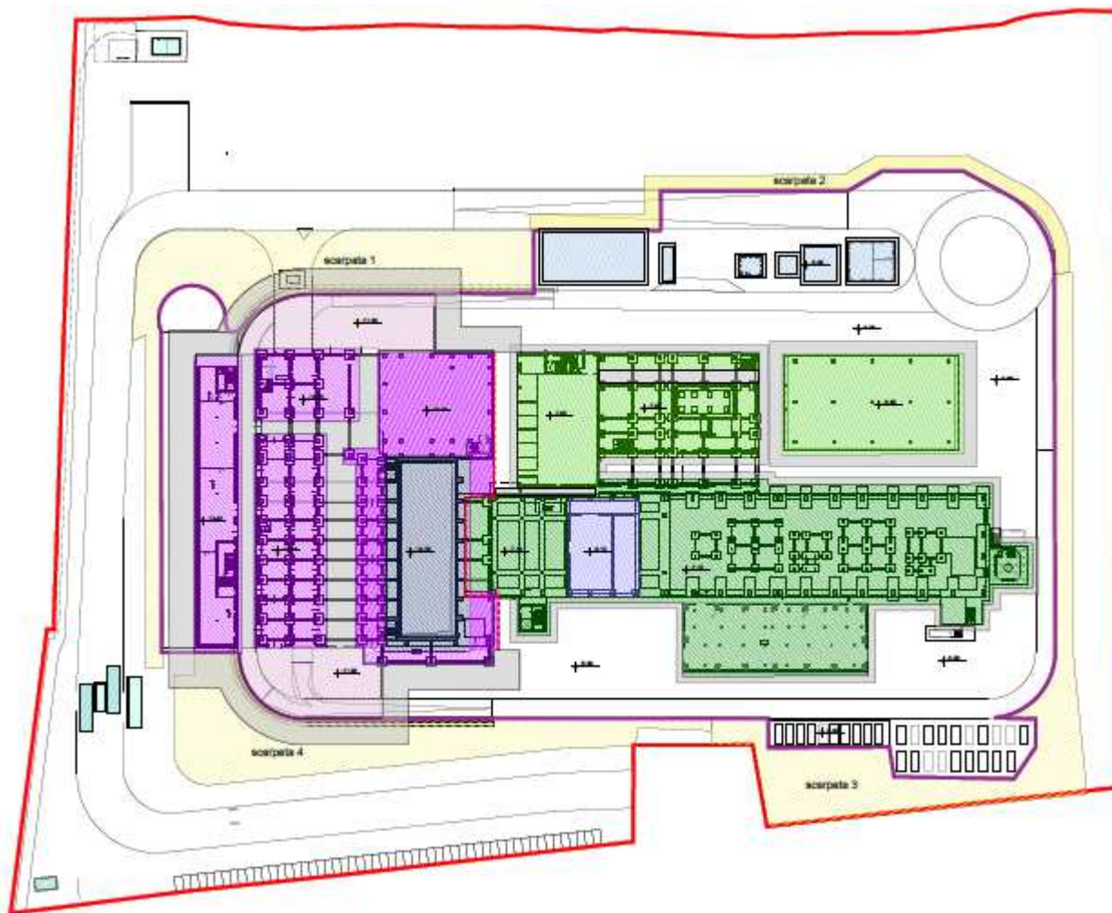
Figura 5 Estratto Tav. 40 con individuazione aree di scavo, in viola le aree a maggior profondità di scavo.
