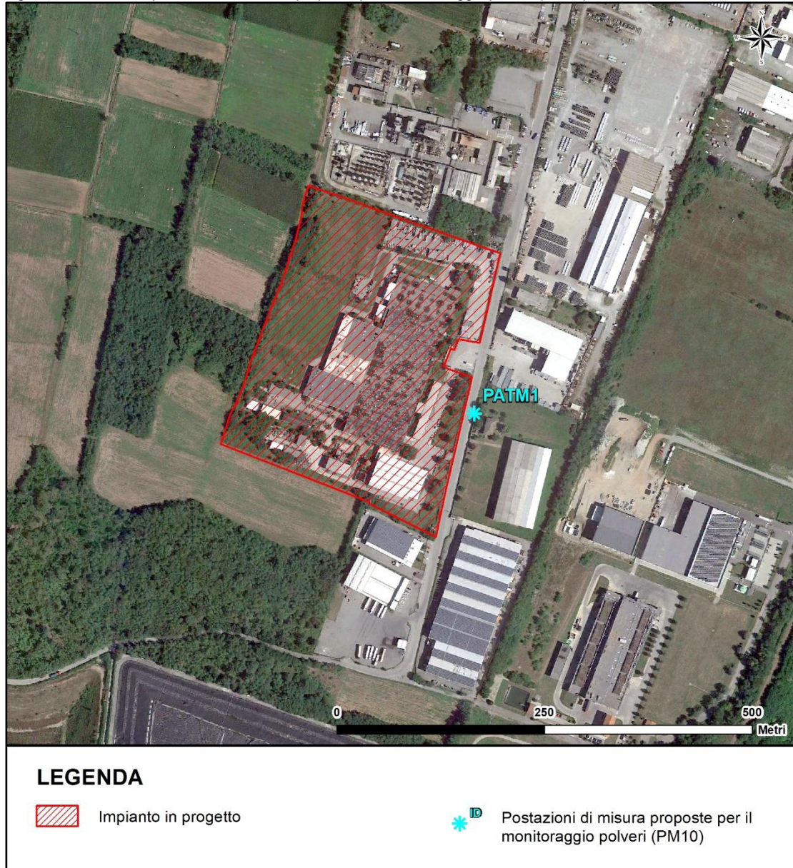
Figura 5a Ubicazione postazione di misura proposta per il monitoraggio polveri (PM10) durante la fase di cantiere
