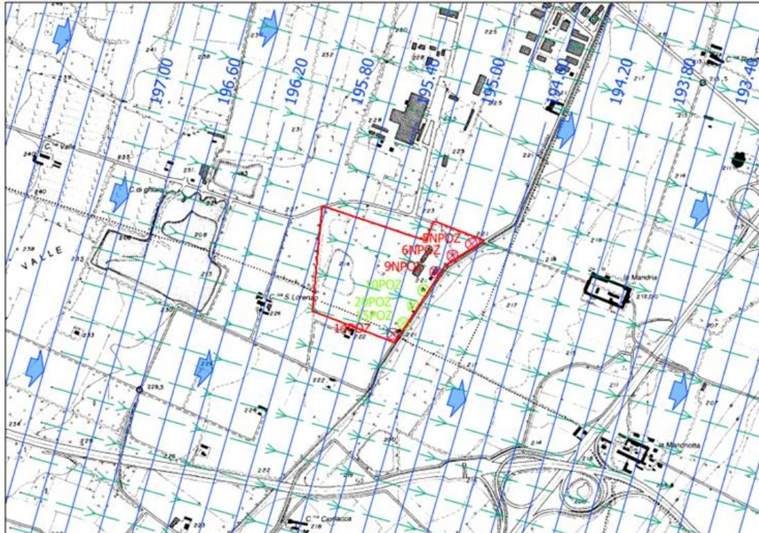
Presi a riferimento le due figure di cui sopra si nota che l'escursione massima della falda dell'acquifero superficiale è di circa 6 metri (da isopieza 195,40 m s.l.m. a 189 m s.l.m.). Prendendo di riferimento la quota topografica 225 m s.l.m. e la minima e massima escursione della falda si può assegnare una soggiacenza variabile tra 30 e 36 m da p.c.
