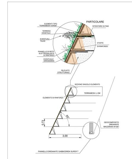
dettaglio tipologico riporto realizzato con terre armate
