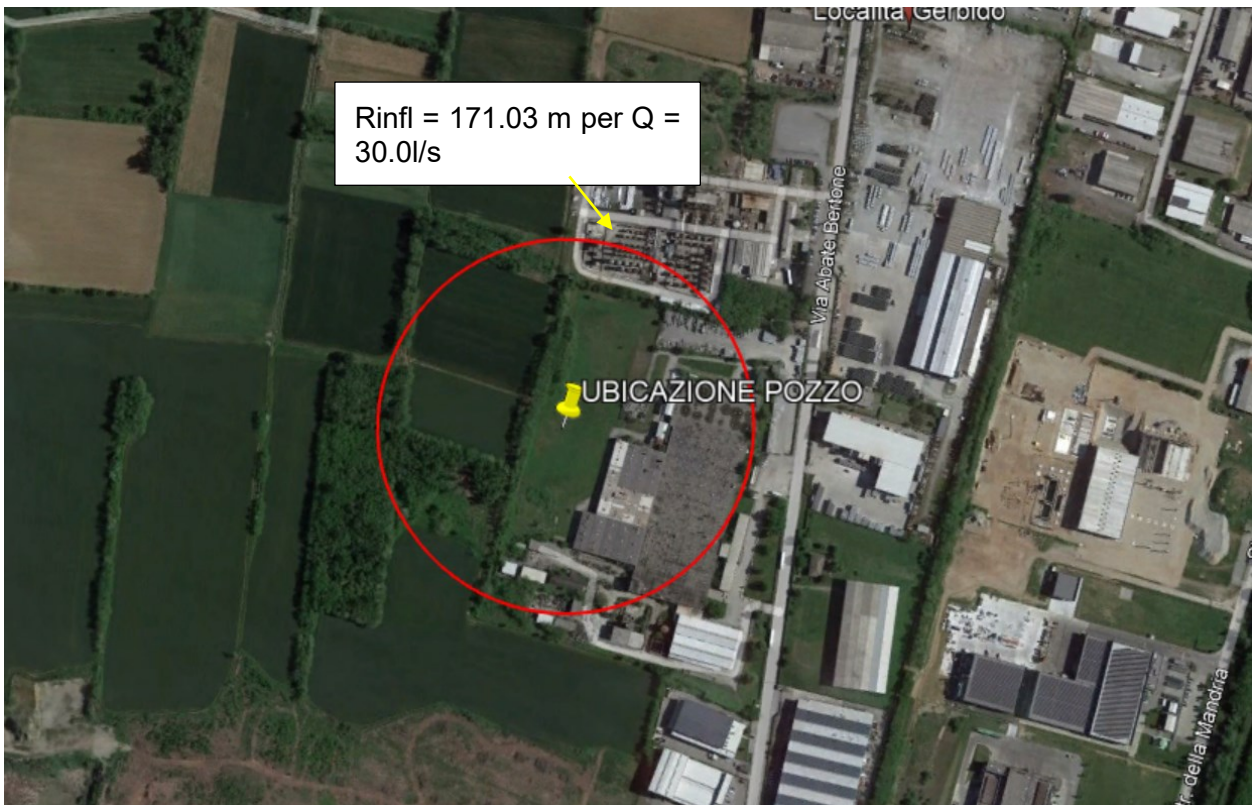
Figura 47 - Ubicazione pozzo - Dettaglio raggio di influenza
