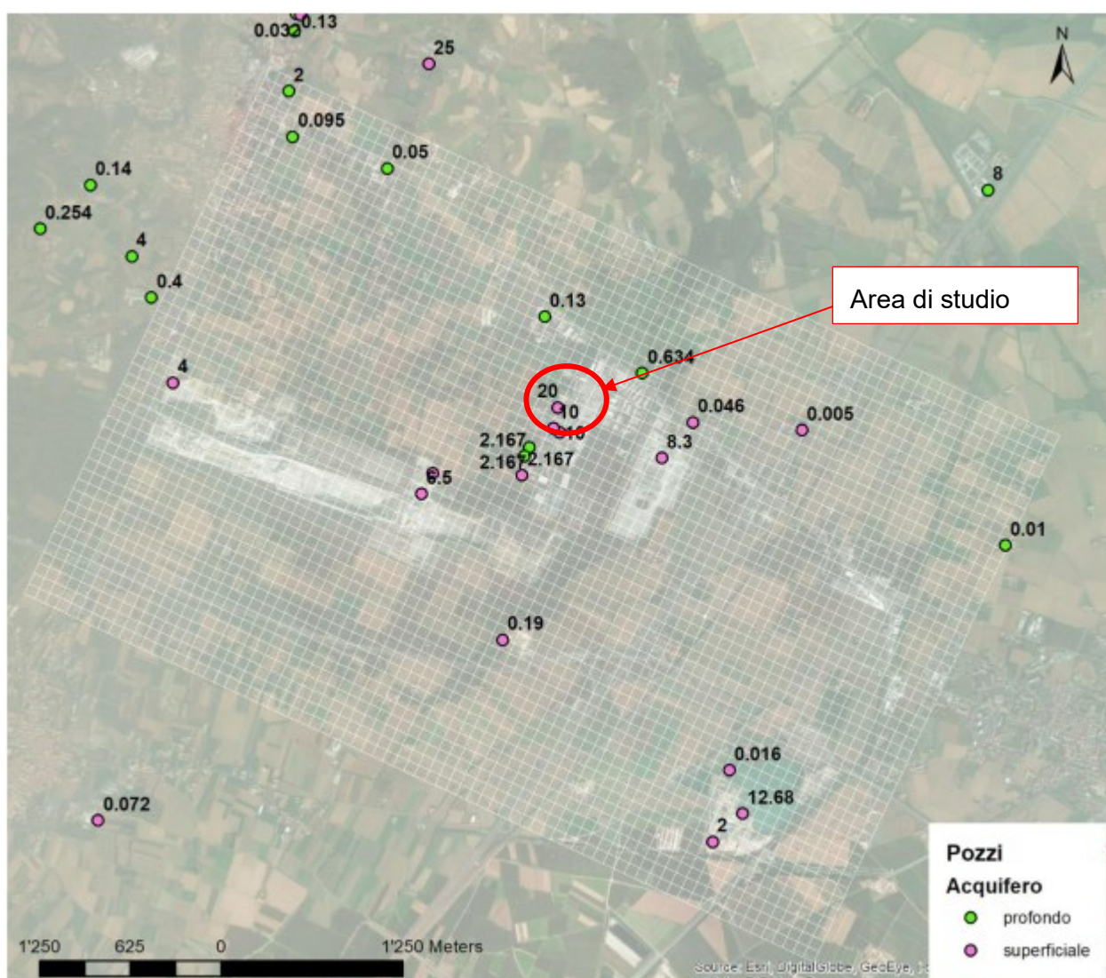
Figura 33: Posizione e portate (in litri/secondo) estratte dai pozzi inseriti nel modello
