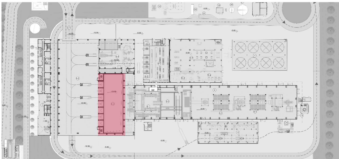
Fig. 13: Vasca principale di stoccaggio rifiuti
