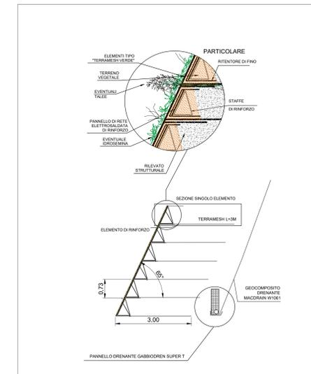
dettaglio tipologico riporto realizzato con terre armate
