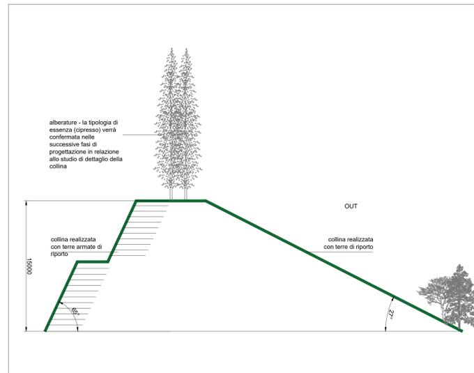
Sezione tipologica collina realizzata con terre di riporto e terre armate
