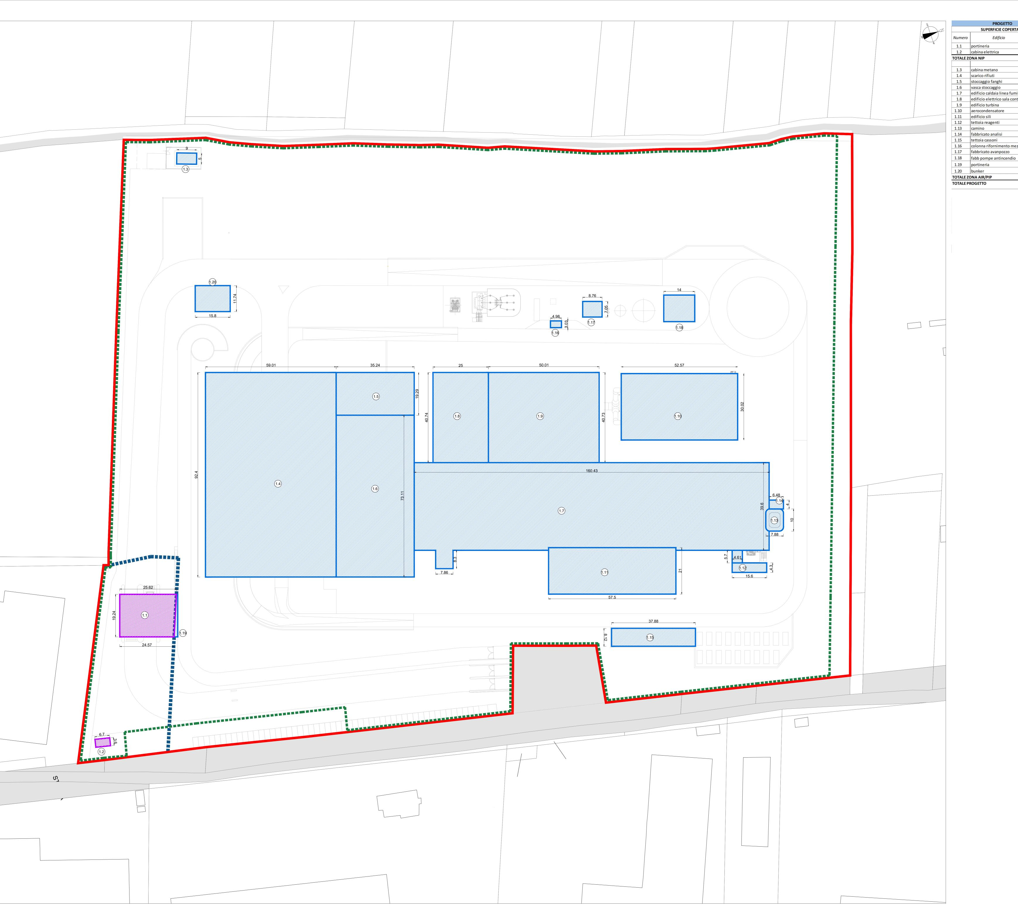
SUPERFICIE COPERTA TU 5.452,20 1.5 stoccaggio fanghi 679,75 1.6 vasca stoccaggio 2.576,10 1.7 edificio caldaia linea fumi 6.327,88 1.8 edificio elettrico sala controllo 1.10 aerocondensatore
