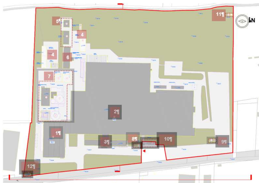
Fig.2 – Ubicazione fabbricati/locali/spazi oggetto di demolizione dello stabilimento Ex Zincocelere – Planimetria
