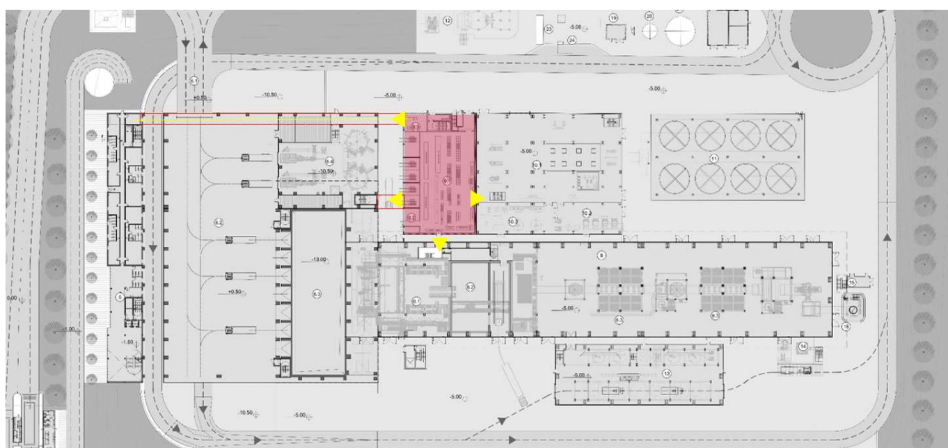
Fig. 7: Fabbricato sala controllo, sale quadri, locale batterie, trafo, archivi ed uffici
