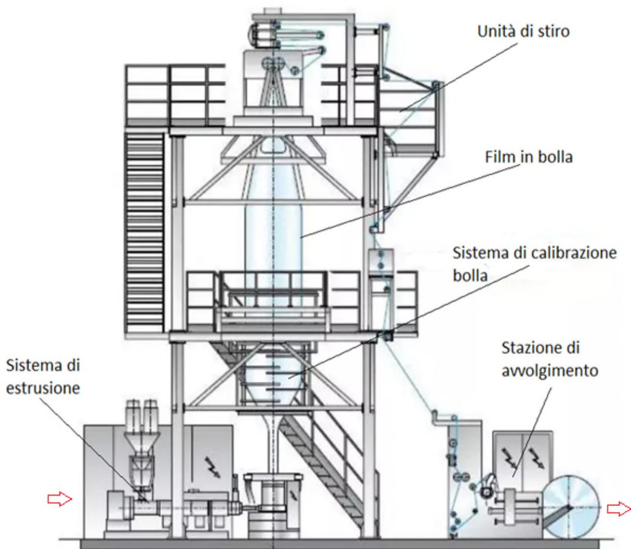
Figura 17: Schema di principio sezione di filmatura
