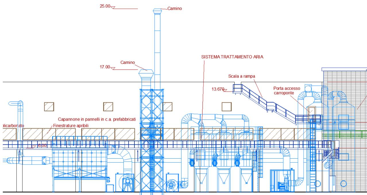
Figura 31: Sistema di trattamento aria, versione attuale – Impianto SRA - Prospetti
