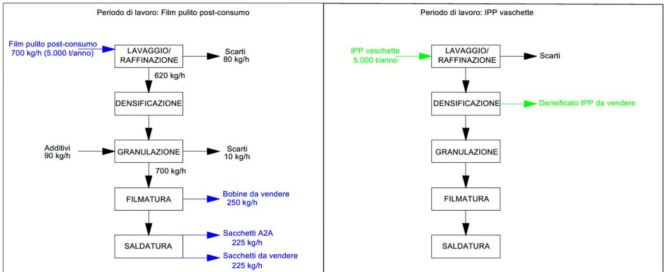
Figura 15: Possibile scenario di funzionamento - Ingressi e uscite
