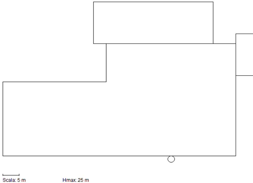
Il coefficiente di posizione della struttura del capannone dell'impianto di selezione delle plastiche è pari a 0,5 essendo una struttura in area con oggetti di altezza uguale o inferiore e non è previsto nessuno schermo esterno alla struttura a meno di effettiva necessità di una misura di protezione aggiuntiva in seguito alla valutazione del rischio.
