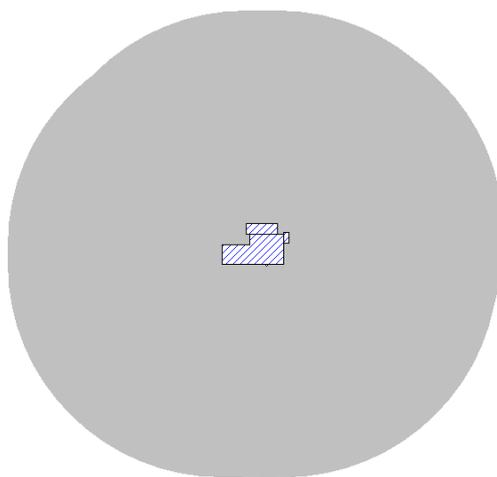
Le aree di raccolta  $A_l$  e  $A_i$  di ciascuna linea elettrica esterna sono state valutate analiticamente
