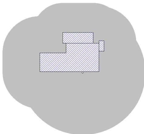
L'area di raccolta  $A_m$  dei fulmini a terra vicino alla struttura, che ne possono danneggiare gli impianti interni per sovratensioni indotte, pari a  $4,62E-01 \text{ km}^2$ , è stata valutata graficamente secondo il metodo indicato nella norma CEI EN 62305-2, art. A.3, ed è riportata nel disegno seguente:
