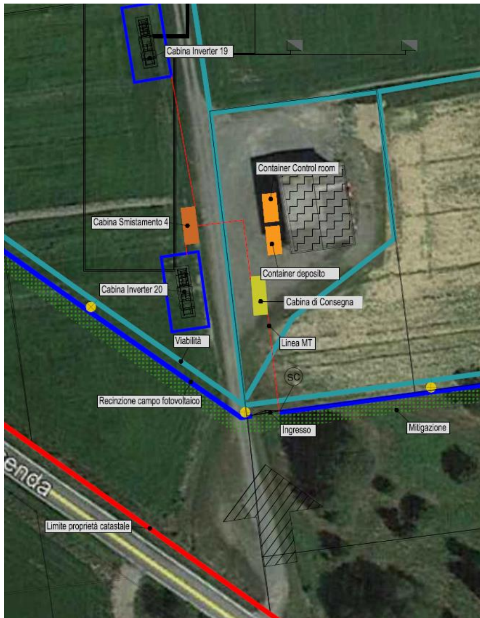
FIGURA 26 - UBICAZIONE DELLA CABINA DI CONSEGNA
