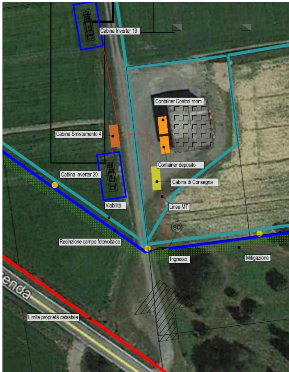
FIGURA 17 - UBICAZIONE DELLA CABINA DI CONSEGNA
