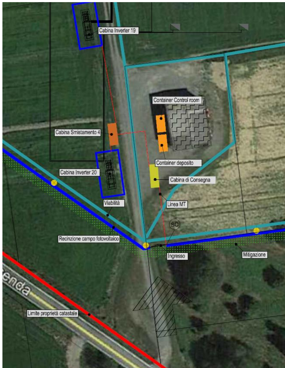
FIGURA 18 - UBICAZIONE DELLA CABINA DI CONSEGNA
