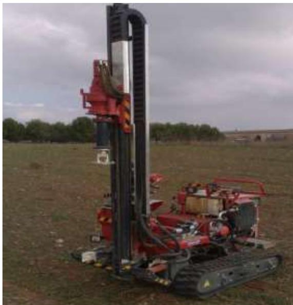
Il lavoro consiste nell'infissione pali con macchina battipalo per l'ancoraggio a terra della struttura portante il generatore fotovoltaico (la struttura portante verrà successivamente montata su palo).
