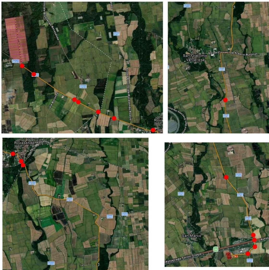
Identificati in rosso, gli attraversamenti tramite TOC 2
