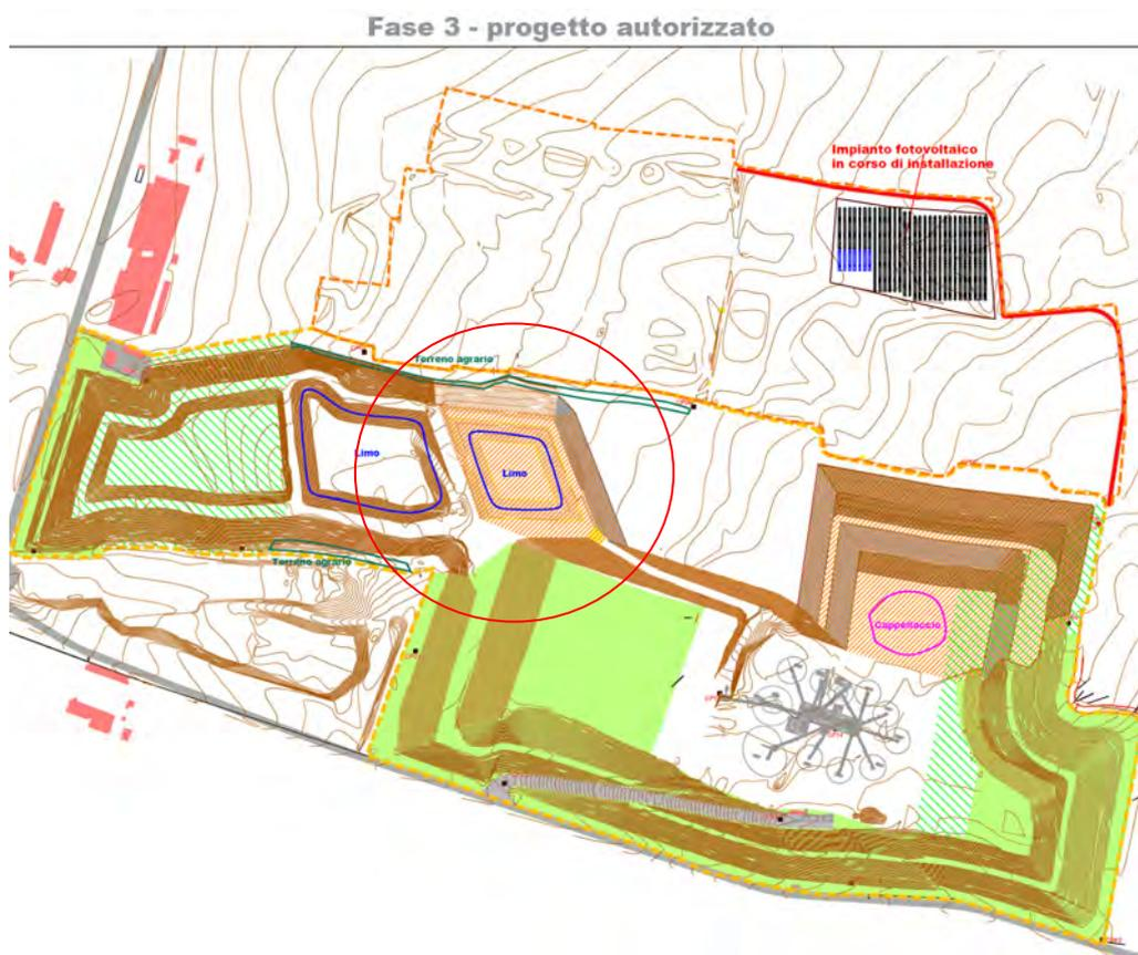
La verifica di stabilità del nuovo setto divisorio tra l'attuale 2° vasca e la nuova 3° vasca limi risulta implicitamente verificata in quanto l'angolo di scarpata dello stesso risulta inferiore (30°) rispetto all'angolo di scarpata esaminato precedentemente nella 2° vasca (35°).
