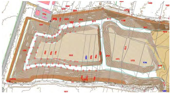
Il setto divisorio tra la zona vasche ed il fondo cava zona impianto è stato valutato in termini di fattibilità mediante analisi di stabilità nella condizione di progetto con metodologie analoghe a quelle descritte ed utilizzate nell'Elaborato B per l'analisi di stabilità delle scarpate. (vedasi *cap. 5.7.6 Elab. A Relazione di progetto*).
