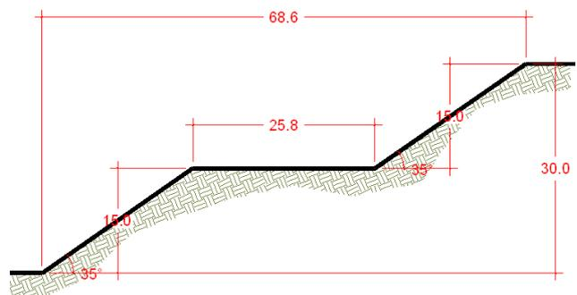
In fase di recupero finale le scarpate saranno riprofilate con un angolo di 20° mediante il riporto del cappellaccio e del limo precedentemente accantonato/prodotto nella cava. Al fine di garantire l'attecchimento delle specie erbacee ed arbustive previste nel progetto di ricomposizione ambientale, nelle scarpate è prevista la stesura finale di uno strato di terreno agrario dello spessore di circa 30 cm.
