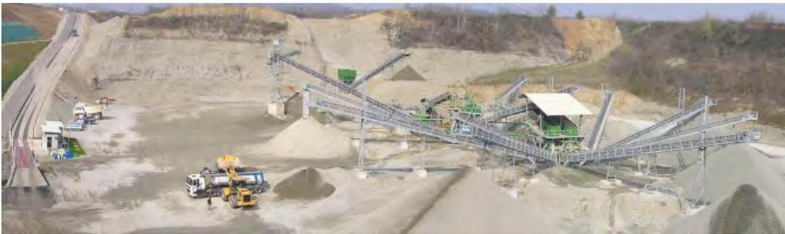
finissime (limi). Quest'ultime vengono inviate alle apposite vasche di decantazione mentre l'acqua chiarificata viene riutilizzata nell'impianto di lavaggio.
