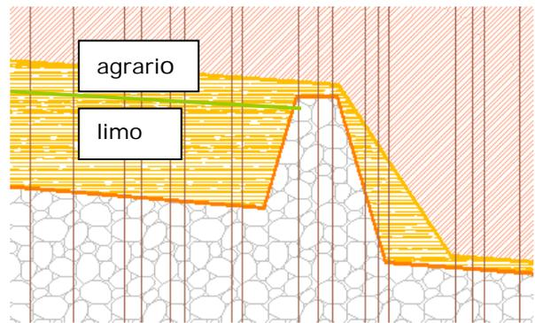
Il processo produttivo prevede il riempimento del primo bacino della vasca per poi passare al secondo bacino, lasciando quindi un congruo tempo di consolidamento del limo per essiccazione depositato nel primo bacino di oltre un anno rendendo quest'ultimo perfettamente palabile.
