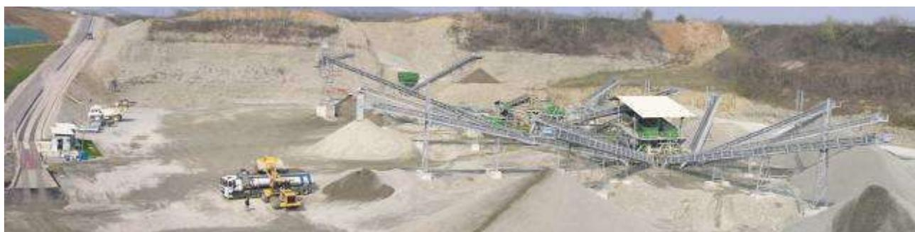
La capacità produttiva dell'impianto è pari a 200 ton/ora.
