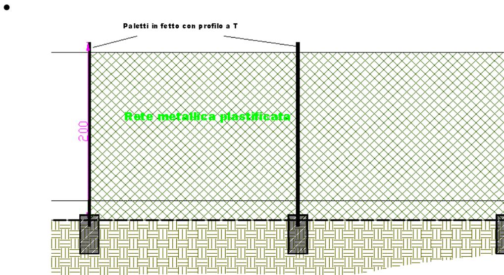
Fig.33 Messa a dimora recinzione da riposizionare al limite N dell'area di ampliamento
