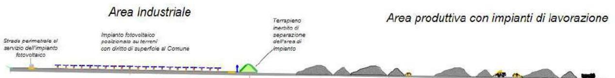
Fig. 31 Estratto Tav. 11\_Costruzione setto di separazione tra l'area produttiva con impianti di lavorazione e area impianto fotovoltaico, su terreni ceduti al Comune di Cavaglià mantenendo l'usufrutto a fini estrattivi, con funzione di barriera contro polveri e rumori.
