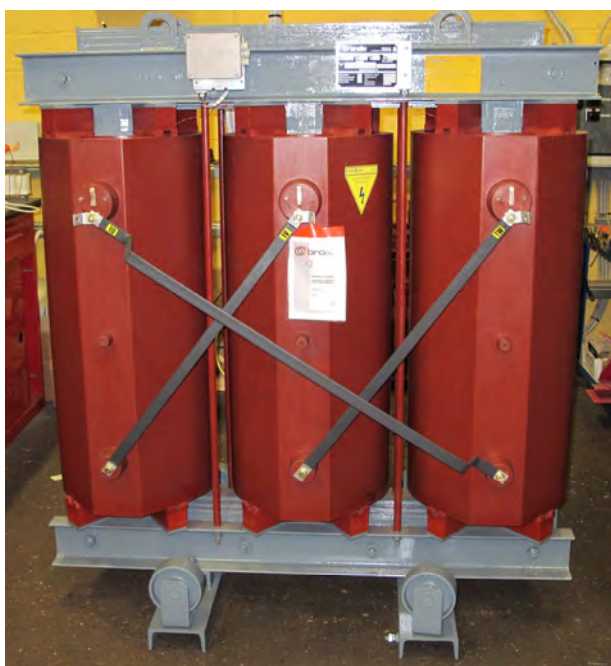
Trasformatore in resina
