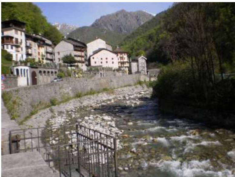
Figura 3.4: l'importanza della roccia per l'edificato rozzazese, la sienite in blocchi utilizzata anche per le sponde del Cervo.
