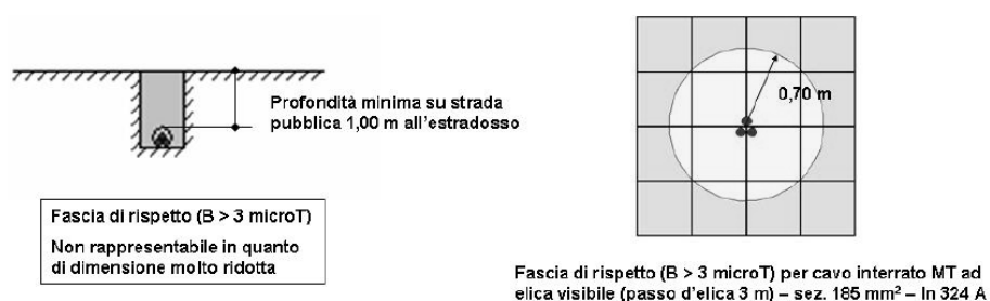
Figura 3 – Curve di livello dell’induzione magnetica generata da cavi cordati ad elica interrati. Calcoli effettuati con il modello tridimensionale “Elicord” della piattaforma “EMF Tools”, che tiene conto del passo d’elica (tratto dalla pubblicazione ENEL “linea Guida per l’applicazione del paragrafo 5.1.3 dell’Allegato al DM 29.05.2008”).
