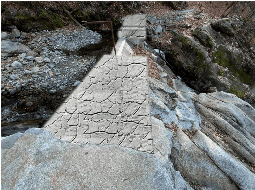
*Figura 1 - rendering rivestimento in pietra locale della presso traversa di presa
