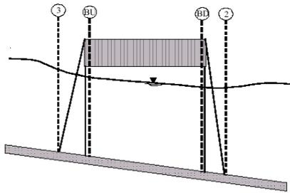
Nel modello costruito si sono valutate le perdite con la formula empirica di Yarnell. Il livello idrico a monte dell'attraversamento (sez. 3 in figura A.1) è calcolato sommando al livello a valle la quantità
