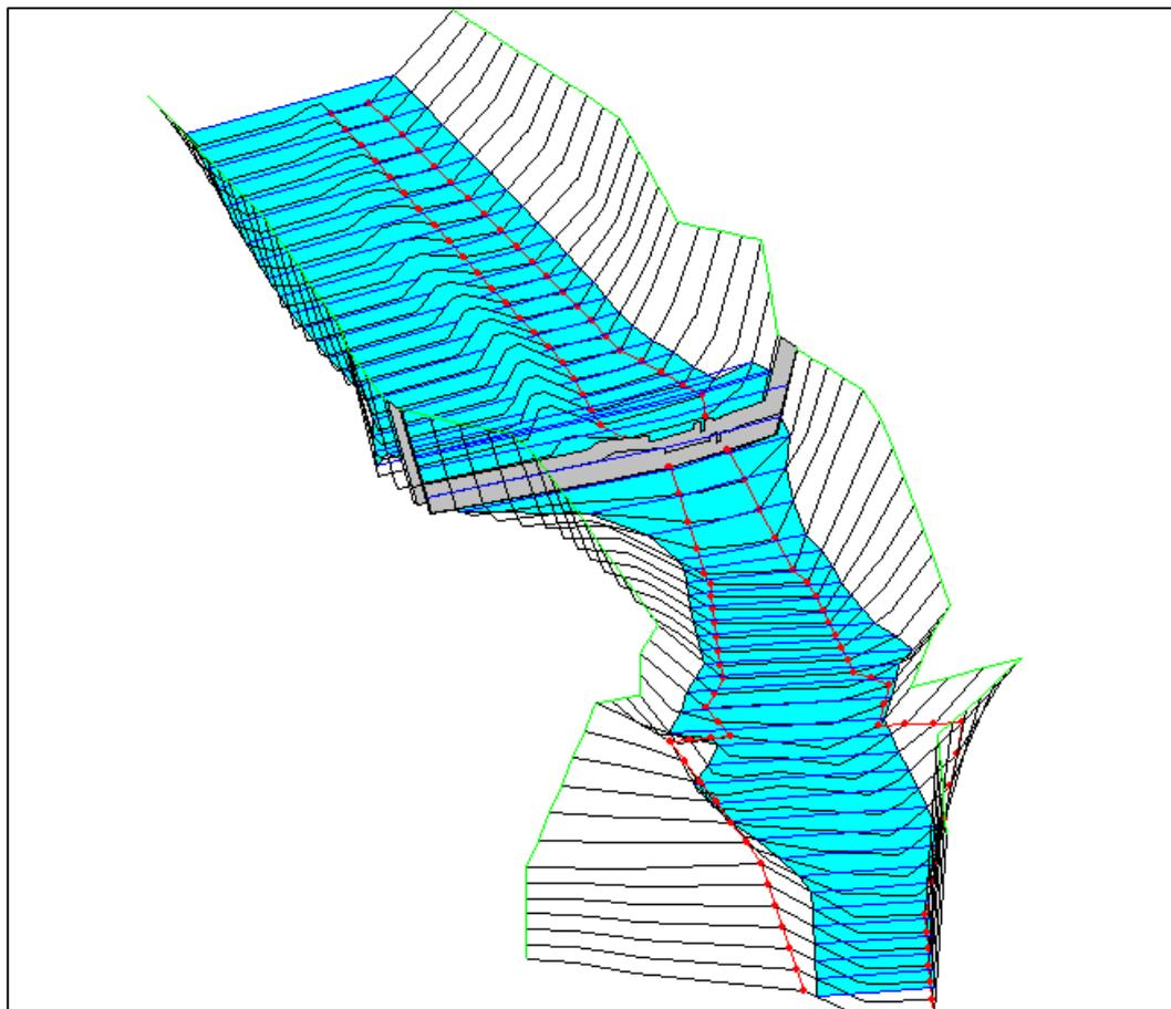
Figura 3.1 La figura riporta la ricostruzione in tridimensionale dell'alveo del T. Concabbia nei pressi del sito di realizzazione dell'opera di presa.
