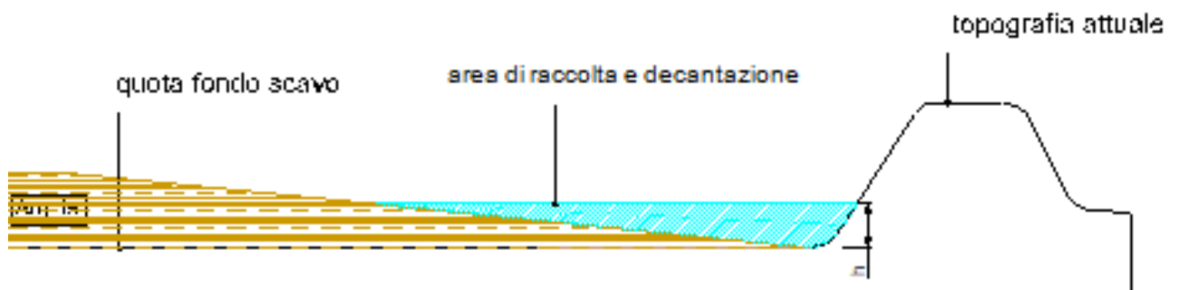
Figura 24 – Sezione tipo dell’area di raccolta e decantazione.
