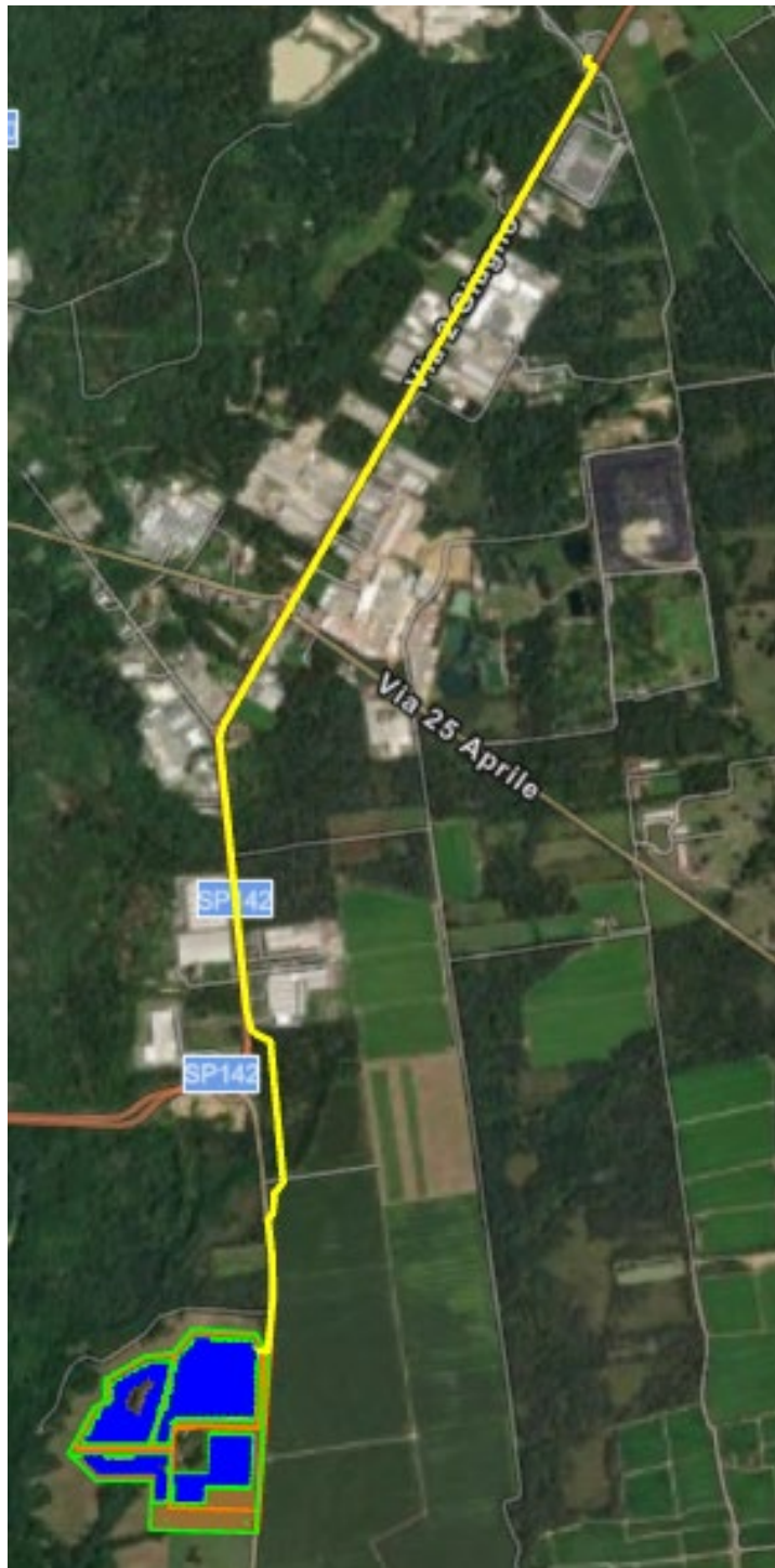
Figura 18 - Collegamento del cavidotto su ortofoto
