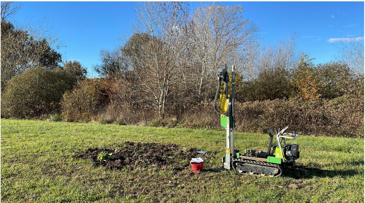
**Esecuzione delle prove penetrometriche DPSH**
