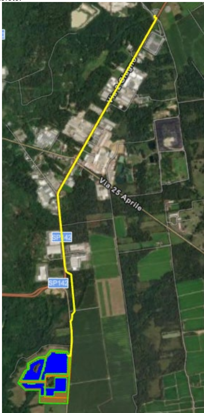
Figura 13 - Collegamento del cavidotto su ortofoto
