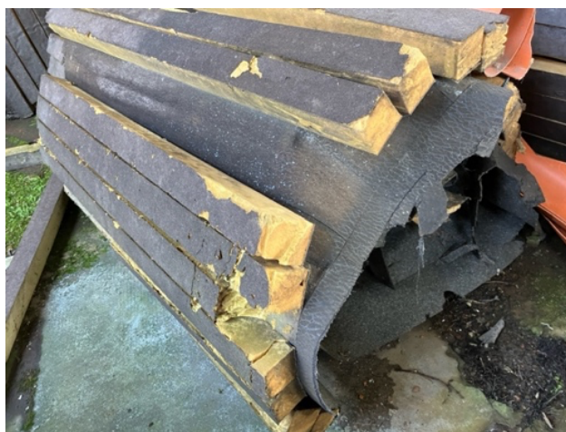
pannelli poliuretanicici con guaina (catramina).
