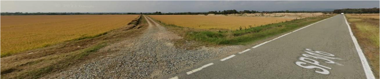
Figura tratta da Google Maps – Incrocio tra la strada di uscita est (Piana C) dell'area di cava (strada vicinale bianca) e la SP 316 la quale verrà spostata di 40 metri a Sud allo scopo di regolarizzare la camera di risaia
