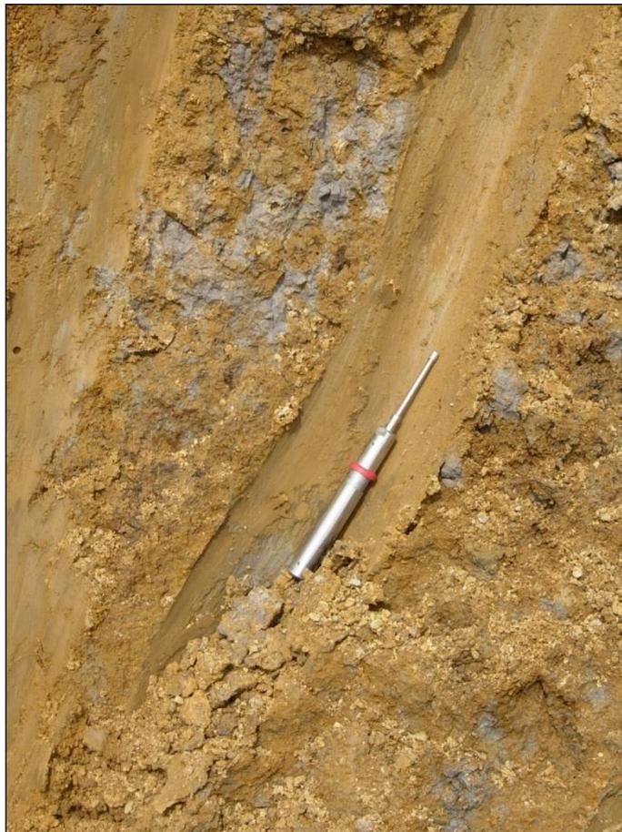
Figura 17 - Particolare della parete del pozzetto esplorativo con Pocket penetrometer.
